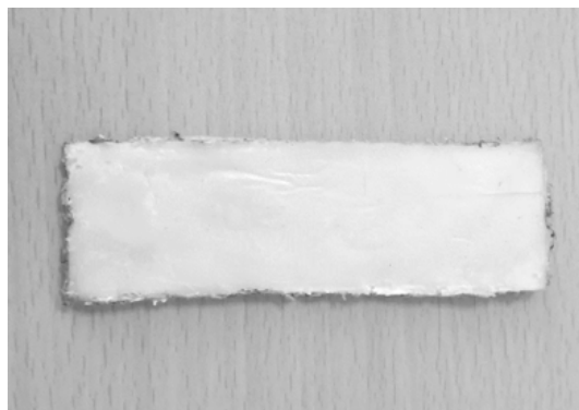
شکل ۴ نمونه پخت شده در دستگاه پرس گرم، پس از جداسازی از قالب Figure 4 A sample cured in a hot press machine, after separation from the mold
