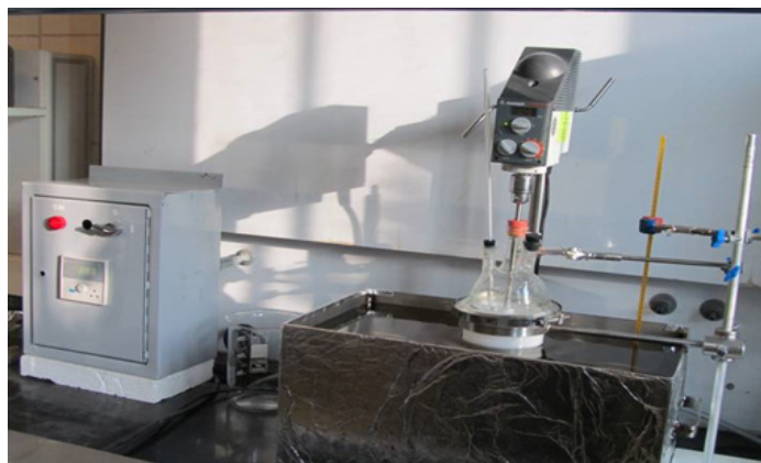
شکل ۱ تصویر راکتور تولید پلی استایرن انبساطی در بعد آزمایشگاهی Figure 1: Reactor used for production of EPS in laboratory scale
