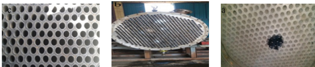
شکل ۴ نماهای مختلف از لوله‌ها و میرد برج تقطیر Fig. 4 Different views of the tubes and condenser of the distillation tower
