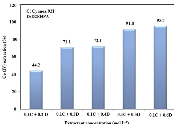
شکل ۱۱ استخراج هم‌افزای سریم (IV) با مخلوط  $0.1 \text{ mol L}^{-1}$  سیانکس ۹۲۱ و مقادیر مختلف  $D_2\text{EHPA}$ .[غلظت یون فلزی در فاز آبی،  $800 \text{ mg L}^{-1}$ ]Fig. 11 Synergistic extraction of cerium (IV) with a mixture of  $0.1 \text{ mol L}^{-1}$  Cyanex 921 and different amounts of  $D_2\text{EHPA}$ .
