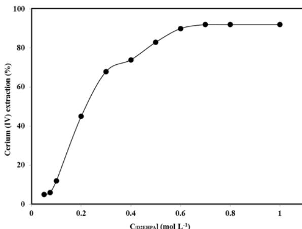
شکل ۱۰ اثر غلظت  $D_2\text{EHPA}$  بر استخراج سریم (IV).[غلظت یون فلزی در فاز آبی،  $800 \text{ mg L}^{-1}$ ؛ دمای واکنش،  $25 \pm 1^\circ\text{C}$ ؛ زمان تماس بین دو فاز، ۳ دقیقه]Fig. 10 Effect of  $D_2\text{EHPA}$  concentration on cerium (IV) extraction[Concentration of metal ions in the aqueous phase=  $800 \text{ mg L}^{-1}$ ; pH=3; Reaction temperature=  $25 \pm 1^\circ\text{C}$ ; Contact time between two phases=3 min]
