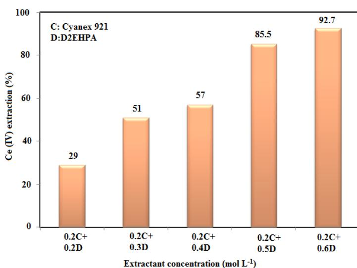
شکل ۱۳ استخراج هم‌افزای سریم (IV) با مخلوط ۰.۳ M سیانکس ۹۲۱ و مقادیر مختلف  $D_2\text{EHPA}$  [اغلظت یون فلزی در فاز آبی  $800 \text{ mg L}^{-1}$ ]
