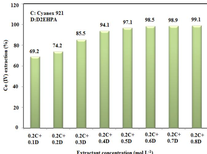
شکل ۱۲ استخراج هم‌افزای سریم (IV) با مخلوط ۰.۲ M سیانکس ۹۲۱ و مقادیر مختلف  $D_2\text{EHPA}$  [اغلظت یون فلزی در فاز آبی  $800 \text{ mg L}^{-1}$ ]
