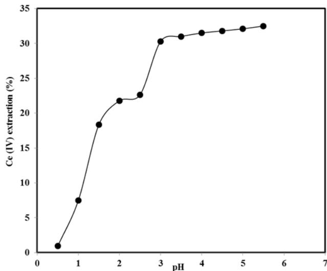
شکل ۲ اثر pH محلول بر استخراج سریم (IV) با  $0.2 \text{ mol L}^{-1}$  سیانکس ۹۲۱[غلظت یون فلزی در فاز آبی  $800 \text{ mg L}^{-1}$ ; دمای واکنش،  $25 \pm 1^\circ\text{C}$ ; زمان تماس بین دو فاز، ۳ دقیقه].Fig. 2 Effect of solution pH on cerium (IV) extraction with  $0.2 \text{ mol L}^{-1}$  Cyanex 921
