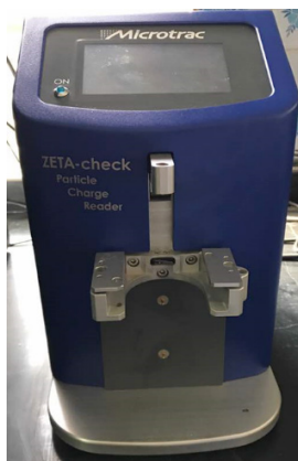
شکل ۳ طرح واره دستگاه پتانسیل زتا (a) سلول حاوی نمونه به همراه پیستون متحرک به منظور سنجش پتانسیل زتا، (b) طرح واره دستگاه پتانسیل زتا مدل Zeta-Check
