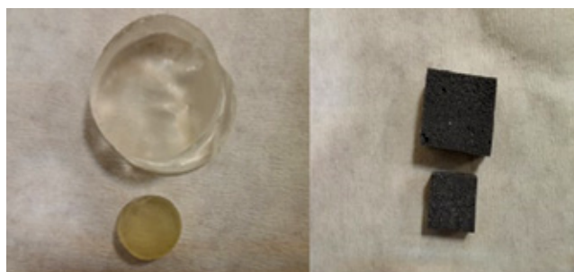
شکل ۷. نمونه‌های رزین و ماده مرکب بسیار پرشده قبل و بعد از متورم‌سازی Figure 7. Samples of resins and highly-filled composites before and after swelling
