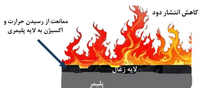
شکل ۲ نحوه سازوکار سامانه‌های تأخیرانداز شعله برپایه فسفر و نیتروژن Figure 2 Mechanism of phosphorus- and nitrogen-based flame-retardant systems
