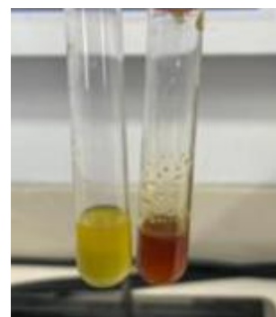
شکل ۶ پلی‌سولفید با جرم مولکولی پایین (قهوه‌ای) بدست آمده از به پلی‌سولفید با جرم مولکولی بالا (زرد)
