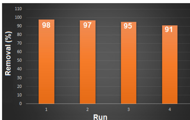
شکل ۸ قابلیت بازیافت و استفاده مجدد جاذب در چرخه‌های متوالی Figure 8. The possibility of adsorbent reusing after sequential adsorption cycles
