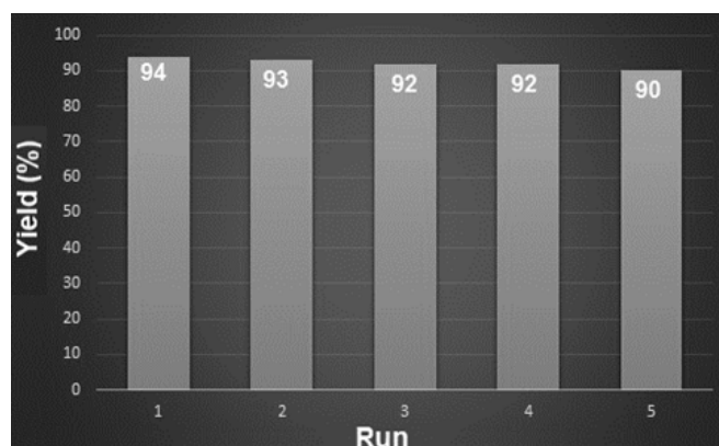
شکل ۷ قابلیت بازیافت و استفاده مجدد از جاذب در چرخه های متوالی Fig. 7 Ability to recycle and reuse the adsorbent in successive cycles.
