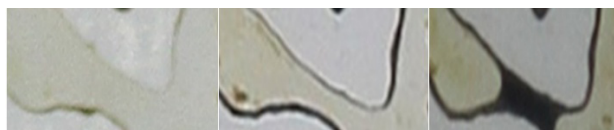
شکل ۵ تغییر ضخامت لایه نفتی برای تزریق سیال الف- DTAB ب- SDBS ج- رامنولپید تولیدی
