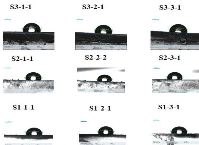
شکل ۹ تصاویر زاویه تماس سه نمونه داربست S1, S2, S3 Figure 9 Contact angle images of S1, S2, and S3 scaffolds
