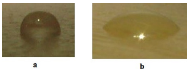
شکل ۹ قطره آب روی سطح نمونه (a) قبل از اصلاح و (b) نمونه اصلاح شده در ۴۰ s Fig. 9. Water droplets on the surface of the sample a. before modification. B. Modified sample in s 40
