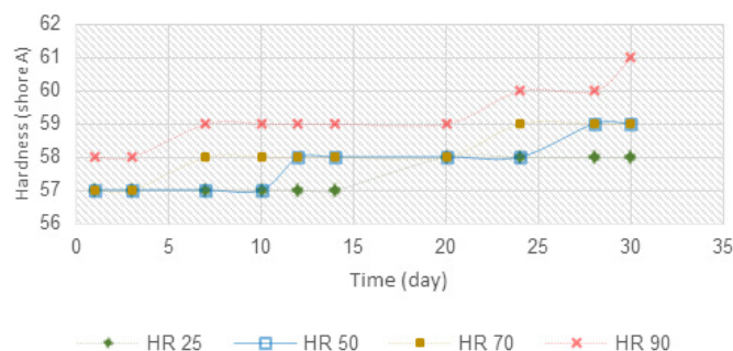
شکل ۶ سختی برحسب زمان (روز) برای نمونه‌های حاوی نانوذره در دماهای ۲۵، ۵۰، ۷۰ و ۹۰ درجه سانتی‌گراد Figure 6. Hardness versus time (day) for samples containing nanoparticles at 25, 50, 70, and 90 °C
