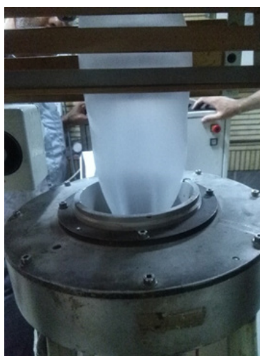
شکل ۱ تولید نمونه ها در حین خروج از دستگاه تهیه فیلم دمشی
