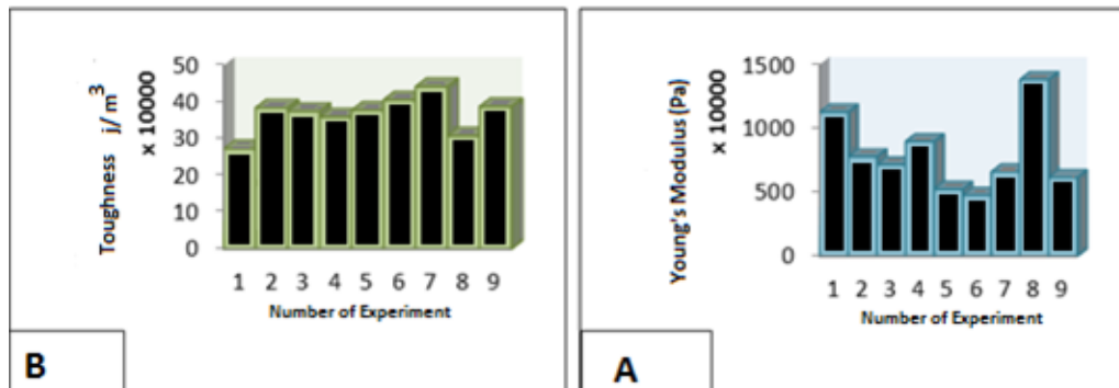
شکل ۲- نمایش گرافیکی تغییرات (الف) مدول و (ب) چقرمگی نمونه های دمبلی شکل Picture -2 Graphical Representation of Changes. A) Modulus B) Toughness of Dumbbell Shape Samples
