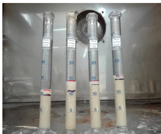
شکل ۸ نسبت تورم ژل ذره‌ای از قبل شکل گرفته در آب‌های تولیدی و دریا در دمای مخزن
