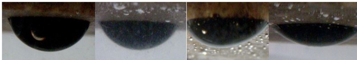
شکل ۱۱ تغییرات ترشوندگی سنگ مخزن پس از ۱ ساعت قرارگیری در محلول (به ترتیب از راست به چپ: محلول پلیمر خالص، محلول نانوکامپوزیت پلیمری با درصد نانو ۰/۲، محلول نانوکامپوزیت پلیمری با درصد نانو ۰/۵ و محلول نانوکامپوزیت پلیمری با درصد نانو ۱)
