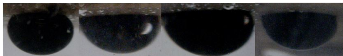
شکل ۱۳ تغییرات ترشوندگی سنگ مخزن پس از ۷ روز قرارگیری در محلول (به ترتیب از راست به چپ: محلول پلیمر خالص، محلول نانوکامپوزیت پلیمری با درصد نانو ۰/۲، محلول نانوکامپوزیت پلیمری با درصد نانو ۰/۵ و محلول نانوکامپوزیت پلیمری با درصد نانو ۱)
