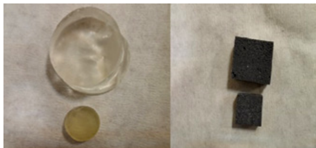
شکل ۷. نمونه‌های لاستیک و ماده مرکب بسیار پرشده قبل و بعد از متورم‌سازی Figure 7. Samples of resins and highly-filled composites before and after swelling
