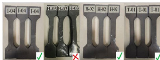
شکل ۹. نمونه‌های ماده مرکب بسیار پرشده H-02، T-01 و I-04 پخت شده و نمونه H-03 پخت نشده Figure 9. Samples of the cured highly-filled composite T-01, H-02 and I-04 and uncured H-03
