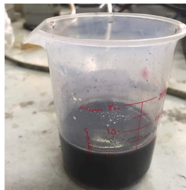
شکل ۲ تصویر نانوسیال حاوی ۱٪ وزنی گرافن و نسبت وزنی گرافن/SDS معادل ۱ به ۱ (۴۸ ساعت بعد از توزیع)
