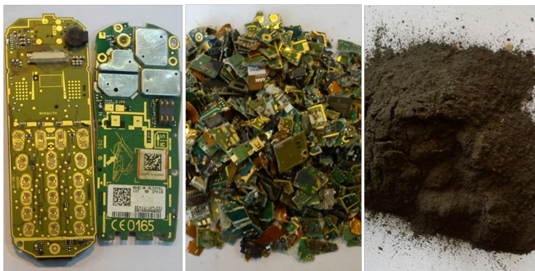
شکل ۱ تصاویر صفحات مدار چاپی در مراحل پودر کردن
