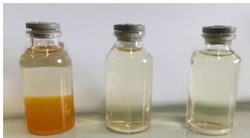
شکل ۱ آزمون پایداری آب‌های دریای ۸ برابر رقیق شده + ۴ برابر غلظت آهن سه ظرفیتی آماده شده در محلول‌های پایه پس از گذشت ۱ هفته Figure 1. Stability test for brine (8dsw4-Fe) prepared in different base fluids after 7 days
