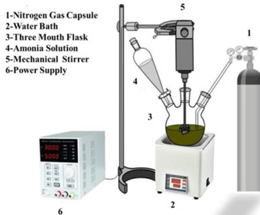
شکل ۱ طرح‌واره سامانه سنتز اکسید آهن مغناطیسی ( Fe_3O_4 ) به روش هم‌رسوبی Figure 1. Schematic of the synthesis system of magnetic iron oxide ( Fe_3O_4 ) by co-precipitation method
