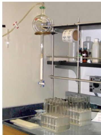
شکل ۱ طرح واره و پایلوت ستون بستر ثابت ACZ مورد استفاده در مطالعه جذب یون نیترات Figure 1. Schematic & pilot Images of fixed bed column ACZ used in adsorption study of nitrate ion
