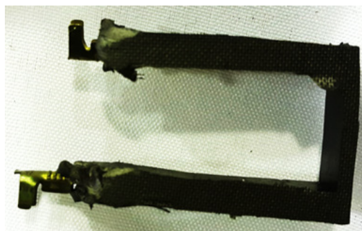
شکل ۱. نمونه کامپوزیت لاستیک نیتریل/گرافیت به همراه اتصالات مسی Figure 1. Nitrile/graphite rubber composite sample with copper joints
