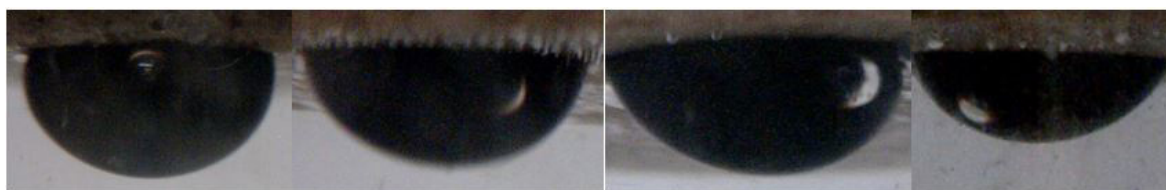
شکل ۱۲ تغییرات ترشوندگی سنگ مخزن پس از ۲ روز قرارگیری در محلول (به ترتیب از راست به چپ: محلول پلیمر خالص، محلول نانوکامپوزیت پلیمری با درصد نانو ۰/۲، محلول نانوکامپوزیت پلیمری با درصد نانو ۰/۵ و محلول نانوکامپوزیت پلیمری با درصد نانو ۱)
