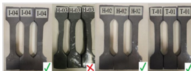
شکل ۹. نمونه‌های ماده مرکب بسیار پرشده T-01، H-02 و I-04 و نمونه H-03 پخت نشده Figure 9. Samples of the cured highly-filled composite T-01, H-02 and I-04 and uncured H-03
