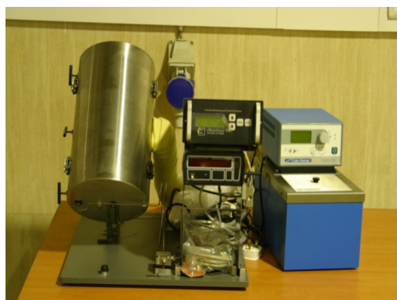
شکل ۱- سیستم آزمایشگاهی استفاده شده برای اندازه‌گیری ویسکوزیته نانوسیال
